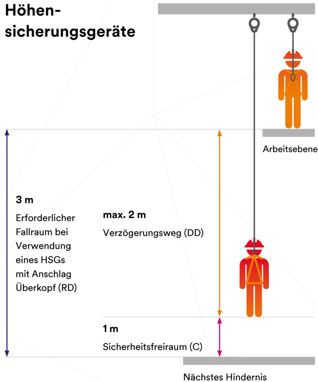
**LL** = Länge des Verbindungsmittels (2 m)
