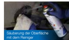
Säuberung der Oberfläche mit dem Reiniger
