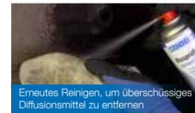
Erneutes Reinigen, um überschüssiges Diffusionsmittel zu entfernen
